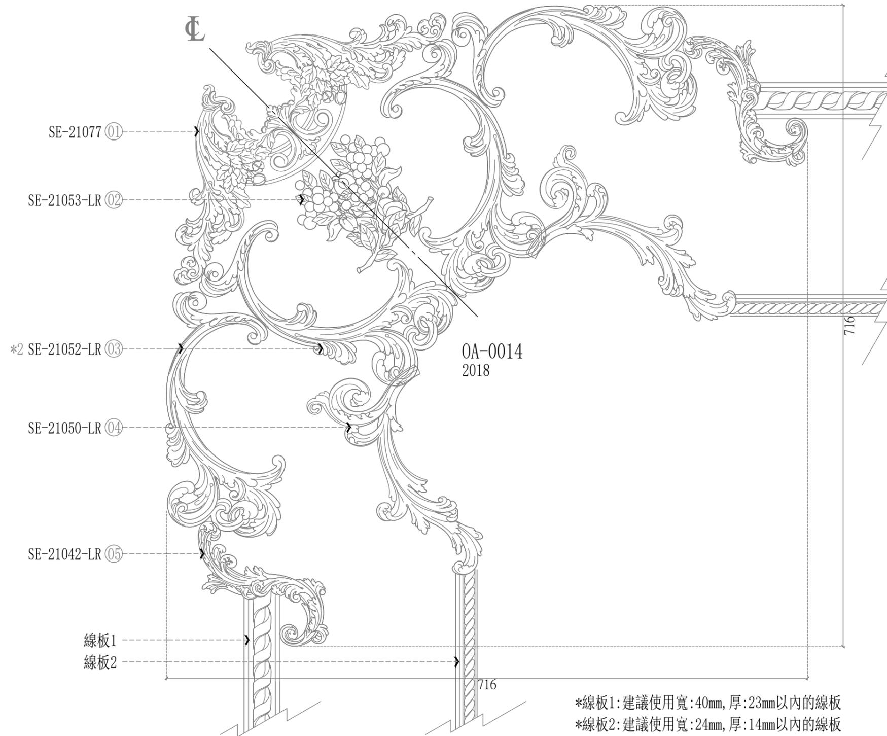
\*線板1: 建議使用寬:40mm, 厚:23mm以內的線板
